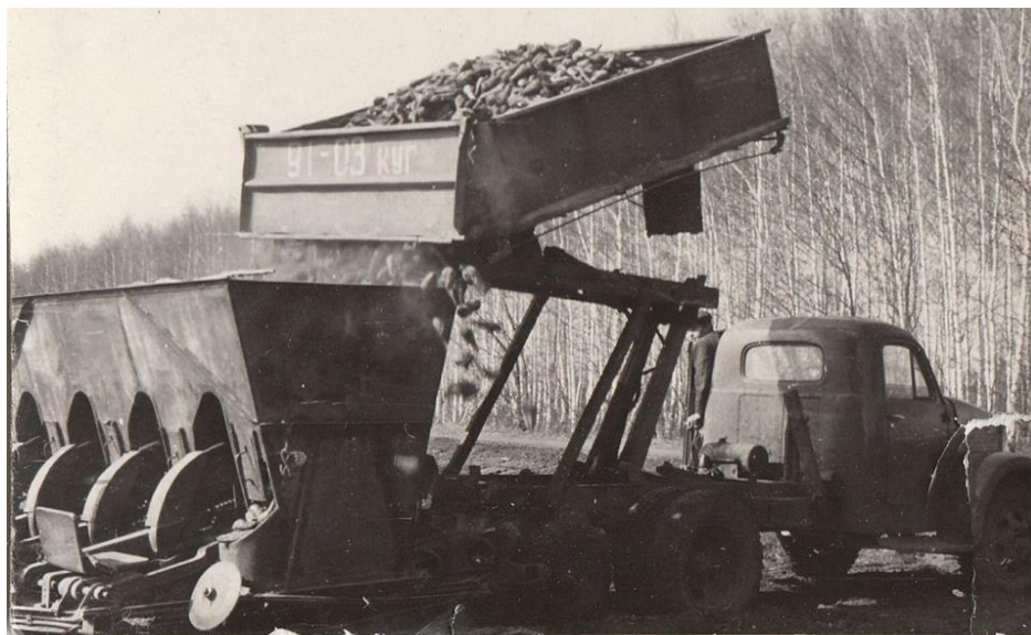
3 - сурет - САЗ-2500 самосвалының ВПГ-4Б отырғызып түсіру машинасының жүктеу сәті
